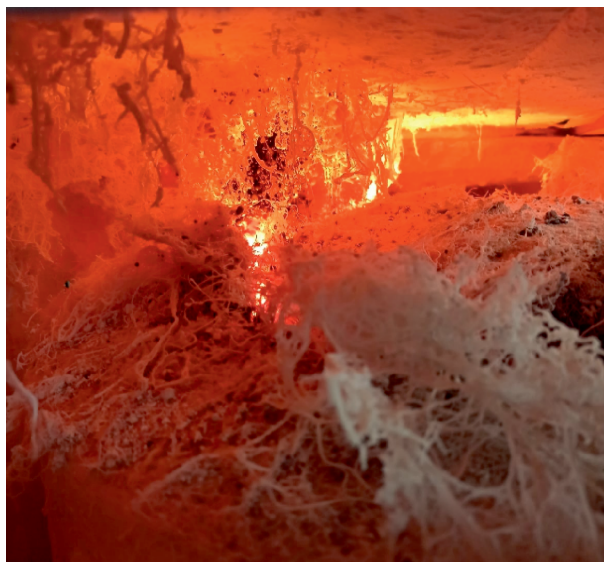
Рис. 6. Фотография зоны воздействия электронного пучка, демонстрирующая обилие волокнистых структур.
